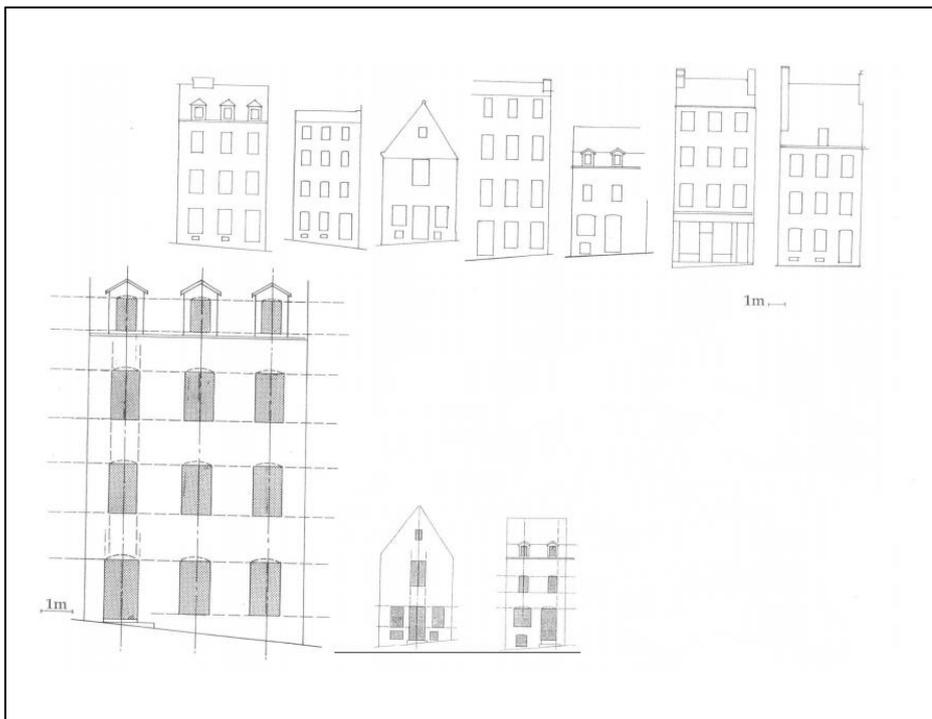
Les percements en façades reprendront le thème de composition le plus répandu : alignement vertical et horizontal des ouvertures, respectant l'échelle et les proportions indiquées ci-contre.
